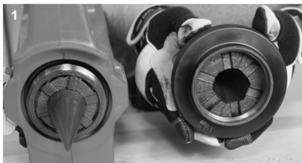
**Figura 13:** Al instalar los cabezales de 2" a 3", asegure que las ruedas dentadas estén alineadas y conectadas con la herramienta.
