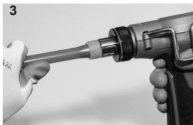
**Figura 7:** Expanda la tubería y el anillo hasta que llegue al collar. Después realice un mínimo de una expansión más.
