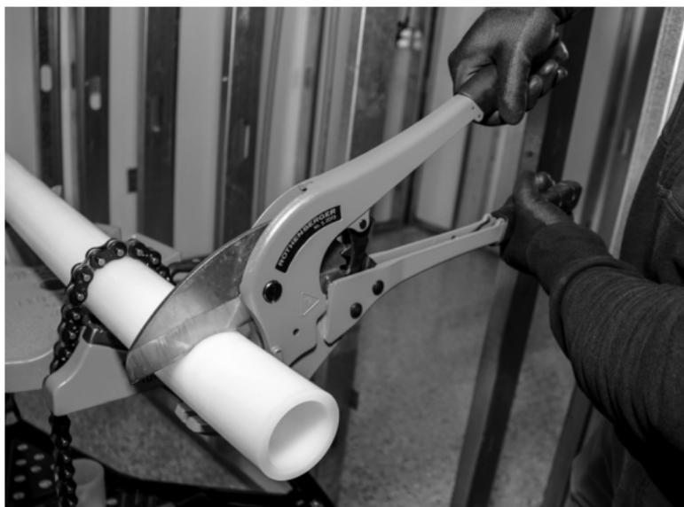
**Figura 17:** Cortatubos Uponor con mecanismo de trinquete para tubería hasta de 3" (E6083000)
