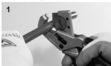
**Figura 5:** Corte la tubería en ángulo recto.
