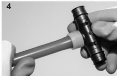
**Figura 8:** Introduzca el accesorio ProPEX completamente hasta llegar al tope de la tubería.
