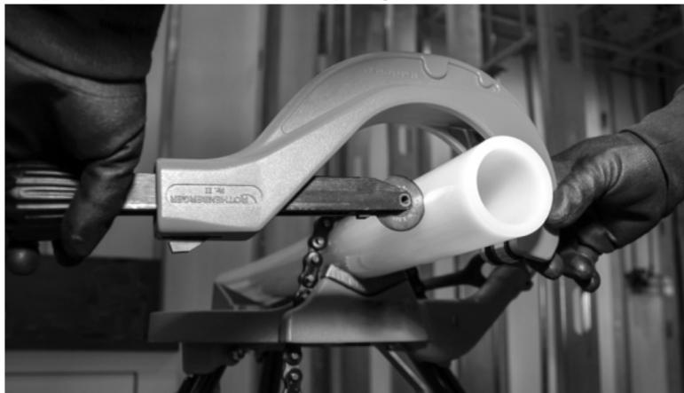
**Figura 16:** Cortatubos Uponor que gira por el exterior para tubería hasta de 4" (E6084000)
