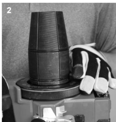
**Figura 14:** El collar del cabezal de expansión debe quedarse apretado contra la herramienta.
